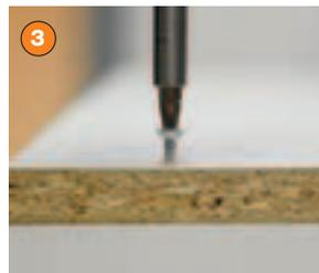
3 Dank der kleineren Gewindesteigung werden die Bauteile schon jetzt zusammengezogen
