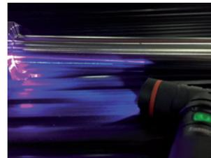
Feine Risse werden mit UV-Licht und fluoreszierendem Prüfmittel sichtbar gemacht.
